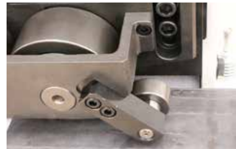
Chaflanado inferior. Upside down bevel.
