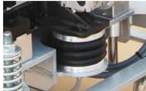
Sist. neumático para ajustar altura de trabajo (OPCIONAL). Pneumatic system to adjust working height (OPTIONAL).
