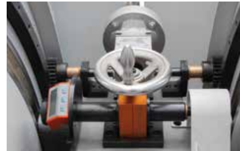
Display electrónico penetración herramienta. Electronic display to control cutter penetration.
